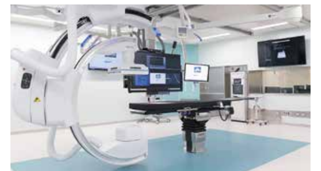
大きなアームが回転してさまざまな角度から撮影できる。 撮影した画像は、リアルタイムで立体表示が可能。
